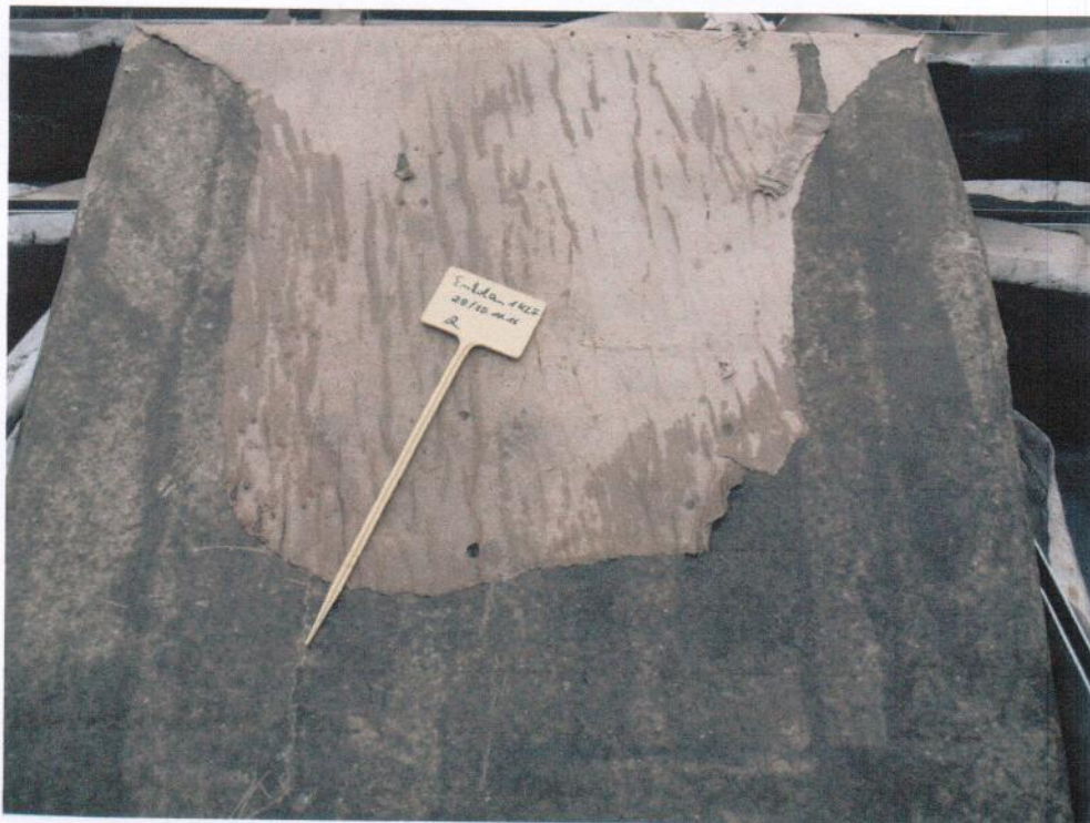
Abb. 2: Abdichtungsunterseite ohne Durchwurzlungen.
