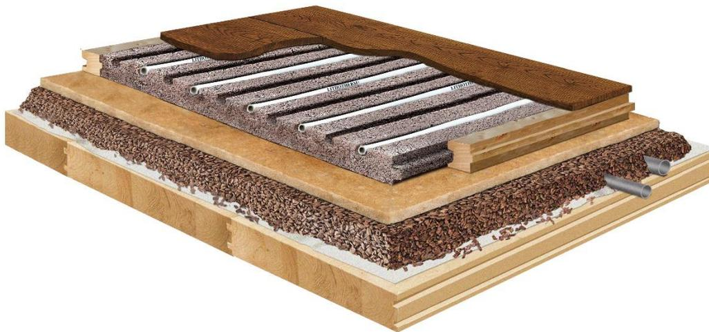
Das LITHOTHERM-System bringt eine vergleichbare Masse mit wie Estrich. D.h., es gewährleistet von Anfang an eine hohe Stabilität. Gleichzeitig sind Gefahren von Setzungen und Bewegungen gemindert, die bei leichteren Trockenestrichen auftreten können.
