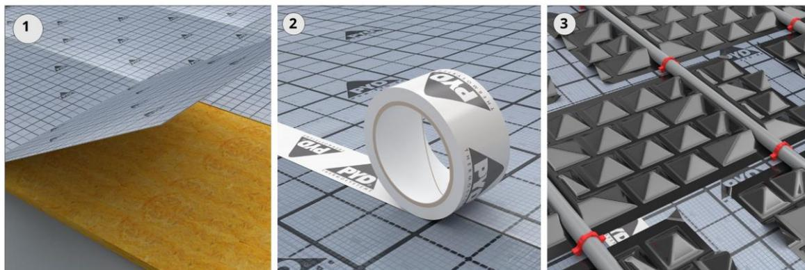
Nach der vollständigen Abklebung an den Stoßseiten ist die Hohlkammer-Verlegeplatte gemäß DIN 18560 und DIN EN 1264 zum Schutz gegen Estrichanmachwasser einsetzbar.
