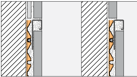
Einbauvariante: Wand-Begrenzungsprofil Schlüter®-QUADEC
