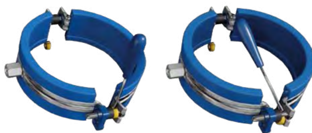
Wechsel von Gleitpunkt zum Festpunkt: Abstandshalter werden entfernt.
