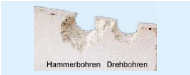
Bild 6 Unterschiedliche Vorschädigung durch Dreh- und Hammerbohren
