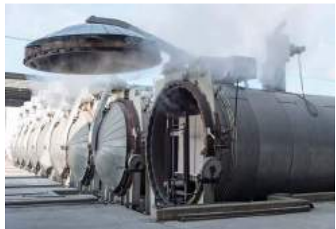
Bild 5 Das Härten der Rohlinge erfolgt in Dampf-Härtekesseln.
