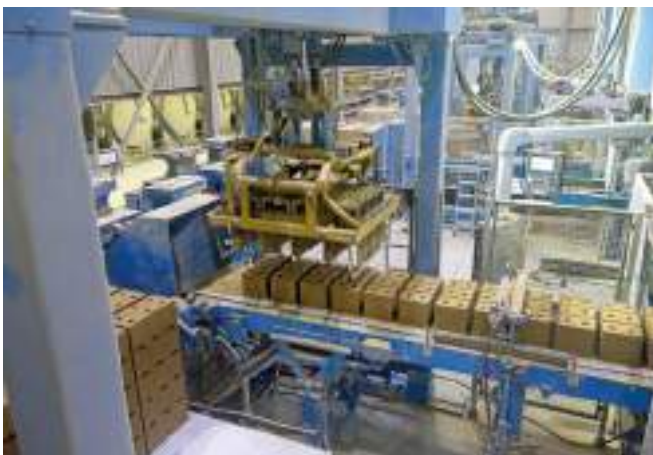
Bild 4 Nach dem Mischen werden die Rohlinge gepresst.
